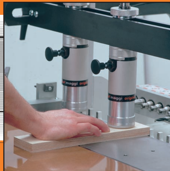
▲ Naše bezpečnostní přítlaky zabrání zranění obsluhy
