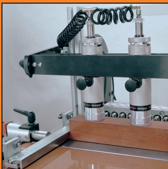
▲ Max. výška pod přítlaky je 80 mm
